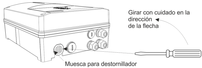
Fig. 17 Retirada del tapón de tubo de la salida de aire
